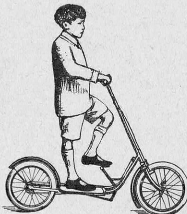
Troticycle "LUCIFER" , type sport, pour enfants de 5 à 15 ans. Direction et moyeux à billes. Roues à rayon montées sur pneus Hutchinson 350 x 35. Freins avant, garde-boue et pompe de cadre.... 429. »
