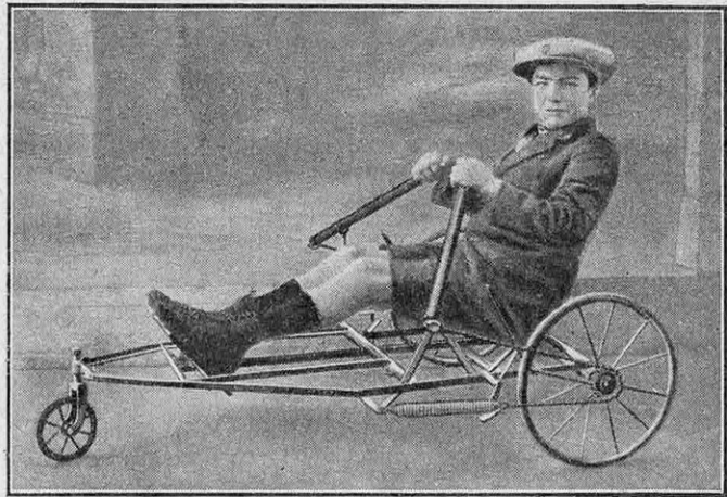
CET APPAREIL, L'« AVIRETTE », PERMET DE SE DÉPLACER SUR LA ROUTE EN EFFECTUANT LES MÊMES MOUVEMENTS QUE SUR UN CANOT
