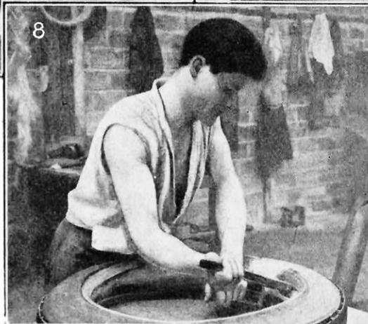
LE PNEUMATIQUE, MUNI DE SA JANTE DE ROULEMENT, EST PLACÉ DANS UNE FRETTE EN ACIER (6) PORTANT DES SCULPTURES D'ALUMINIUM QUI S'IMPRIMERONT
