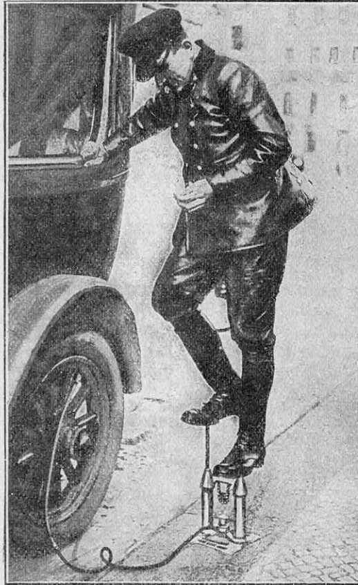
UNE POMPE ORIGINALE POUR GONFLER, SANS FATIGUE, LES PNEUMATIQUES D'AUTOMOBILE
