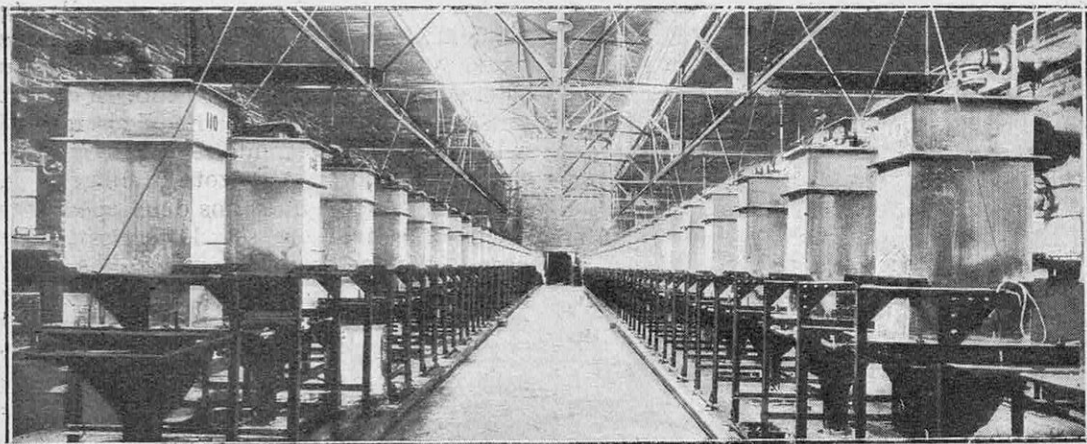
FIG. 1. — TRANSFORMATION DU GAZ AMMONIAC EN ACIDE AZOTIQUE
