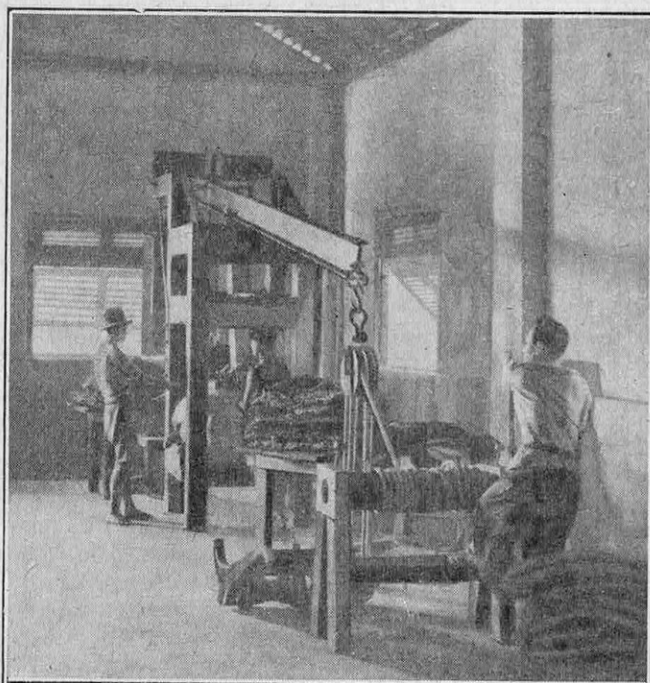
FIG. 14. — COMPRESSION A LA PRESSE DES BALLES DE CAOUTCHOUC AVANT EXPÉDITION
