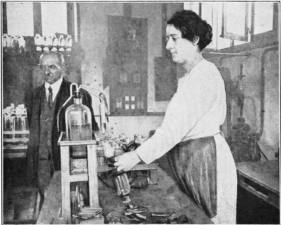
FIG. 5. — REMPLISSAGE DE LA DOUBLE PAROI POUR L'ARGENTURE
