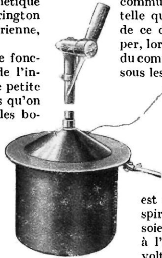
LE MOTEUR A INDUCTION QUI CONSTITUE LA BOUSSOLE
