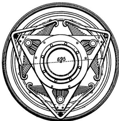
FIG. 7. — TRANSMISSION ÉLASTIQUE DU MOUVEMENT DE LA TURBINE LJUNGSTRÖM
