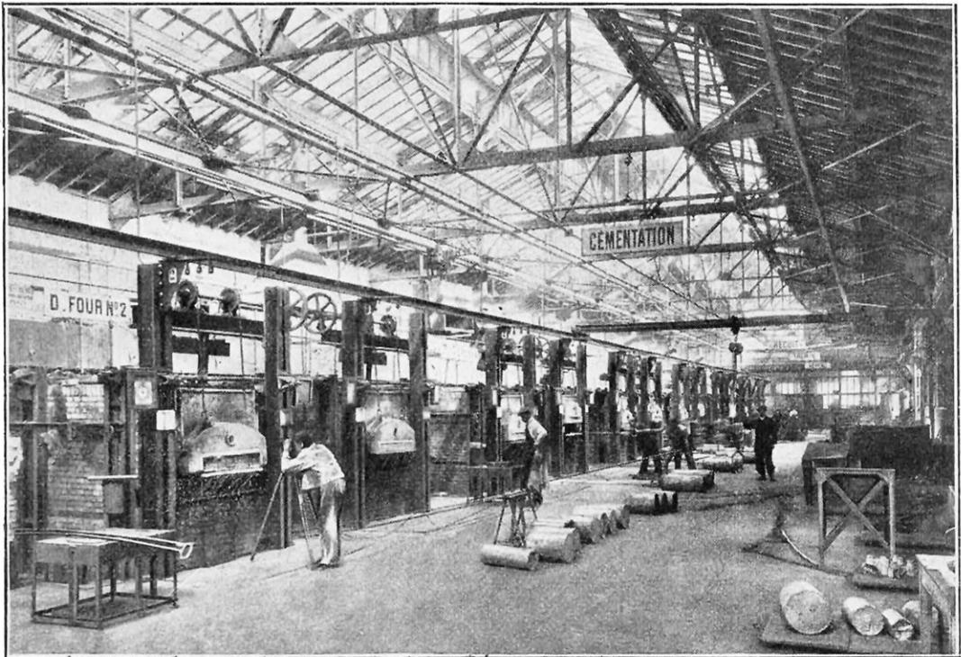
SALLE DES FOURS POUR LE TRAITEMENT THERMIQUE DES PIÈCES DE MÉCANIQUE
