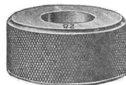
TAMPON SIMPLE DE 28 MILLIM. ET BAGUE NORMALE CALIBRÉE A LA MÊME DIMENSION
