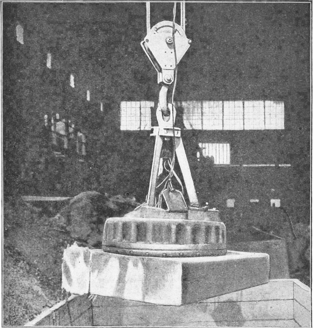
GRUE A ADHÉRENCE MAGNÉTIQUE FONCTIONNANT DANS UNE ACIÉRIE
