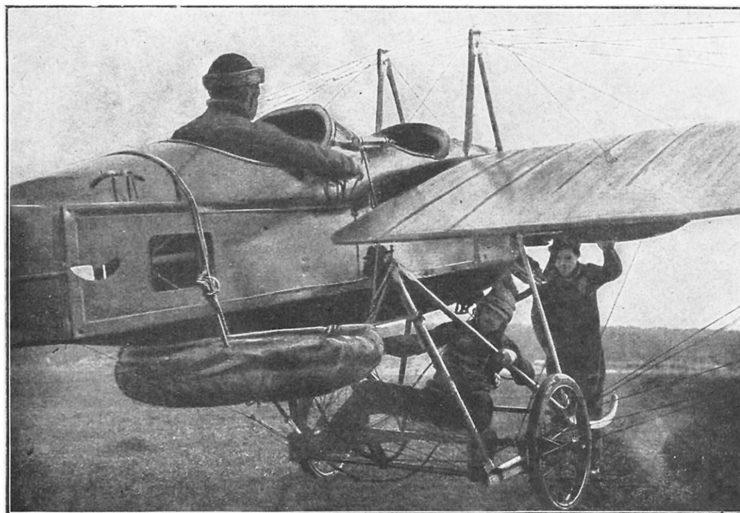
EXPÉRIMENTATION DU PARACHUTE « ORS » A BORD D'UN MONOPLAN DEPERDUSSIN
