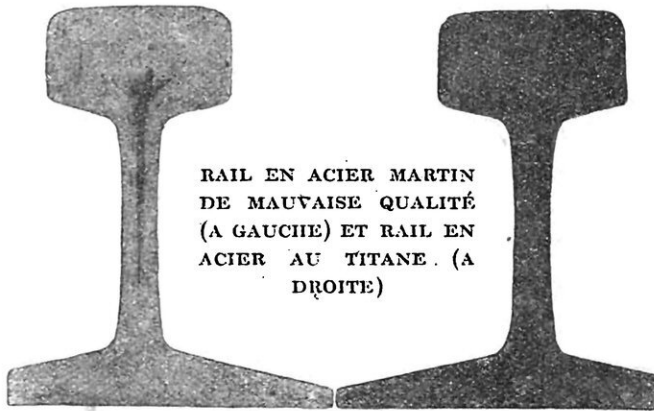
Ces deux coupes montrent que l'acier au titane présente une texture homogène, tandis que l'acier Martin mal fabriqué donne lieu à des soufflures intérieures qui diminuent considérablement la résistance du rail et peuvent même occasionner sa rupture.
