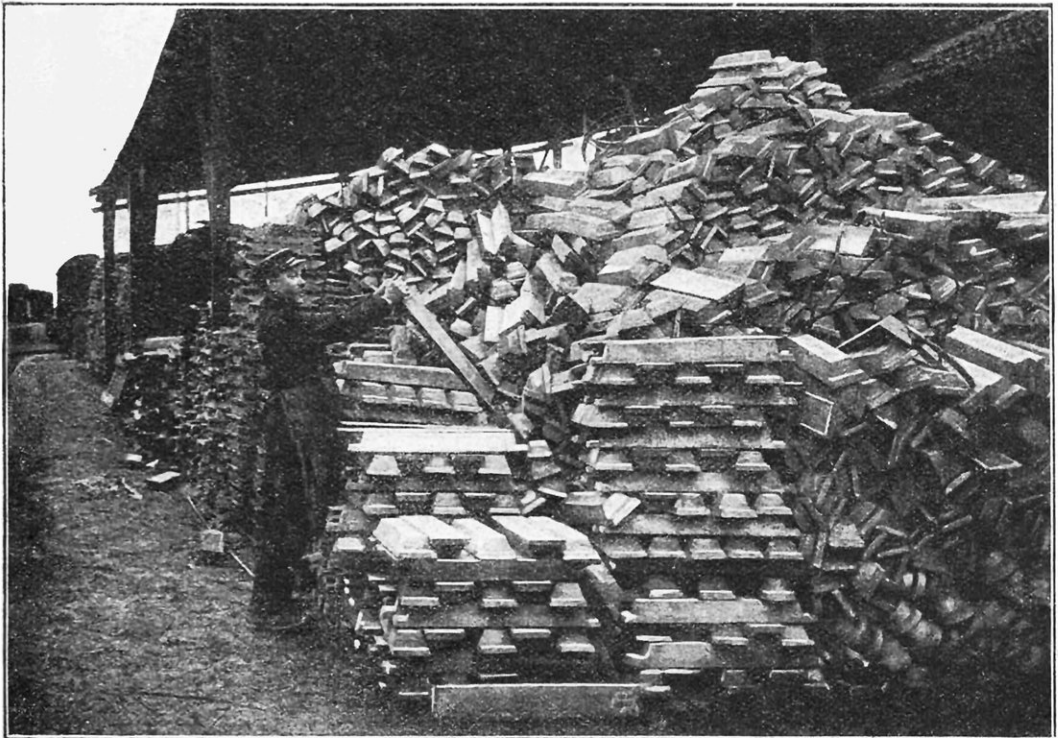
SAUMONS DE PLOMB ET D'ANTIMOINE DESTINÉS A OBTENIR L'ALLIAGE QUI SERT A LA FABRICATION DES BALLES SPÉCIALES POUR SHRAPNELLS
