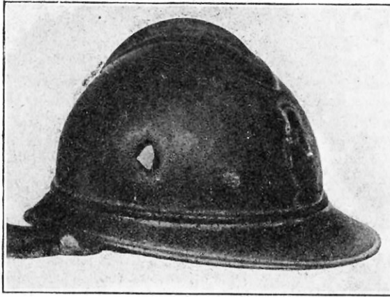
TROU FAIT PAR UN ÉCLAT D'OBUS DANS UN CASQUE ADRIAN, EN TÔLE D'ACIER
