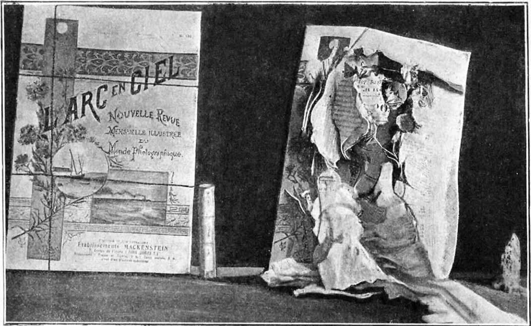
FIG. 3. — DE GAUCHE A DROITE : CIBLE EN PAPIER CONSTITUÉE PAR UN PAQUET DE REVUES : LE PROJECTILE EN PAPIER ; LE PAQUET DE REVUES COMPLÈTEMENT LACÉRÉ APRÈS LE TIR ; LES DÉBRIS, RÉDUITS DES DEUX TIERS, DU PROJECTILE EN PAPIER
