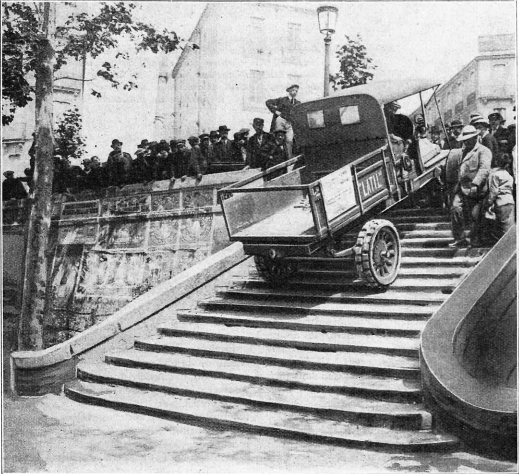
LES CAMIONS A ADHÉRENCE TOTALE PEUVENT GRAVIR UN ESCALIER SANS PATINER Le tracteur Blum-Latil, que représente cette photographie, muni d'un moteur de puissance moyenne (15 chevaux), a monté les marches d'un escalier près de la gare de Béziers.
