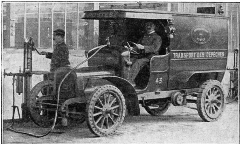
UNE VOITURE DES POSTES FAIT SON PLEIN D'ESSENCE AVEC L'APPAREIL « BOWSER » SANS DANGER D'INCENDIE, NI D'EXPLOSION, NI DE PERTE.
