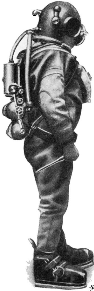
Vue de profil d'un plongeur revêtu d'un scaphandre à fonctionnement indépendant, modèle anglais, du système Siebe et Gorman.
