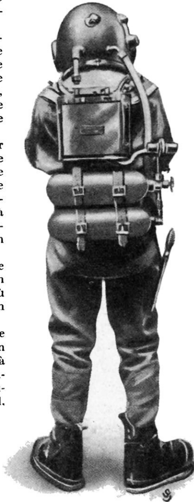
Vue de dos d'un plongeur revêtu d'un scaphandre à fonctionnement indépendant, modèle anglais du système Siebe et Gorman.
